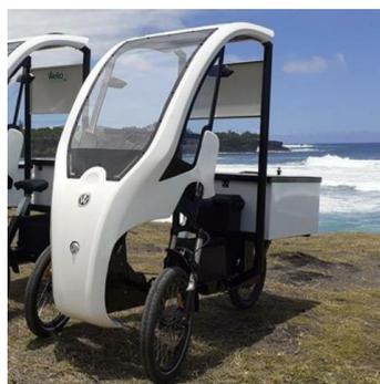
Créé à la Réunion en 2015 par Arnaud Chereau, le Wello est un vélo triporteur pendulaire à assistance électrique, solaire et connecté, pour rassembler en un même véhicule urbain les atouts à la fois du vélo (agilité, faible impact environnemental, facilité de stationnement) et de la voiture (confort, sécurité, connectivité, capacité d'emport).
